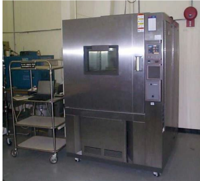
Figure 28: Espec ESZ-4CA Thermal Chamber
